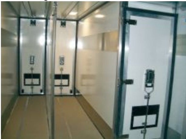
Mehrkommer-Kühlsystem mit variablen Trennwänden
